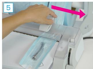
カッターをスライドさせて滅菌パックを切ります。滅菌パックの反対側もシールします。
