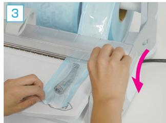
滅菌パックを引き出してレバーを倒します。
