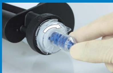
濃紺色ダイナミックミキサーを時計回りに右回しロックし、準備完了。
