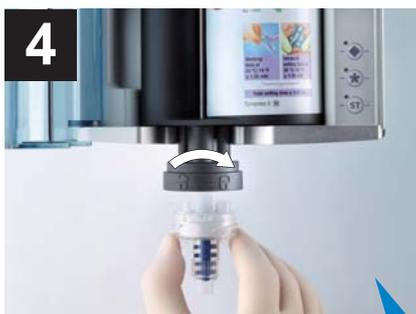
4 濃紺色のダイナミックミキサーを黒カートリッジに正しく挿入・装着。
