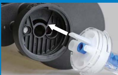
濃紺色ダイナミックミキサーの白凸部を黒カートリッジ凹部に正しく挿入。
