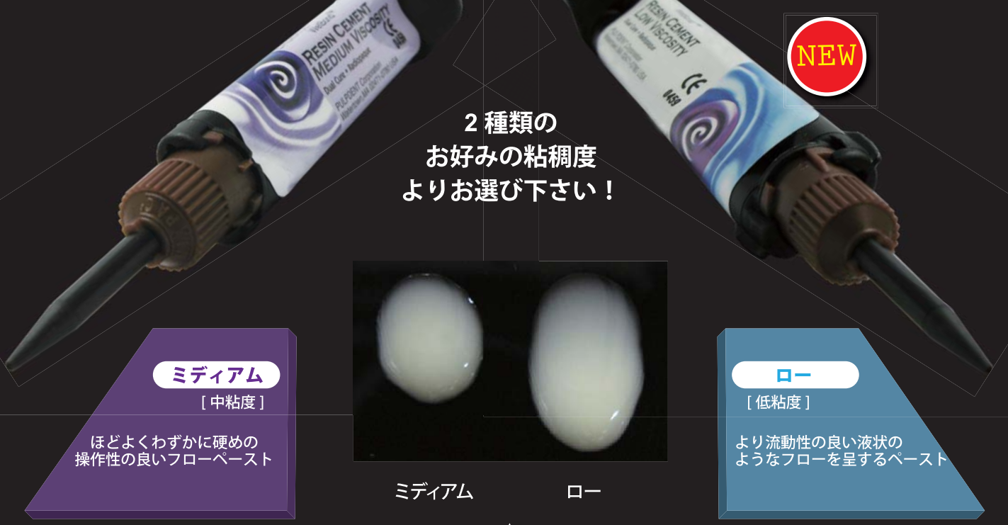
写真は、2種類の粘稠度の両ペーストを、等量黒い板上に滴出し、斜めにして1分間経過したものです。
