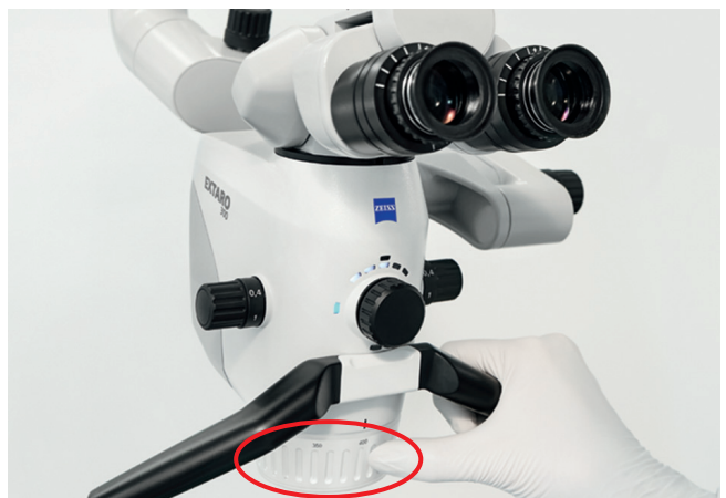
パリオスコープ230 (焦点距離を200mm～430mmまで変更可能な対物レンズ)
