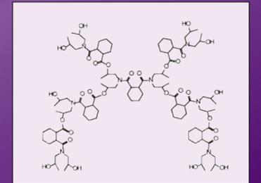
コンポコアAFに含有されている新素材「ハイパーブランチ」モノマー末端は多数の官能基を持ち3次元スピード重合を実現。官能基どうしの結合によりコア材の重合・硬化が促進される為より完全な重合を促進します。
