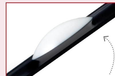
ガラス板を斜めに傾けて安定性をテスト
