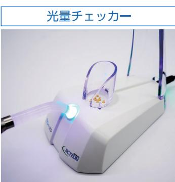
光量checkerにチップの先端をあてて、照射すると簡単に光量をチェックすることができます。
